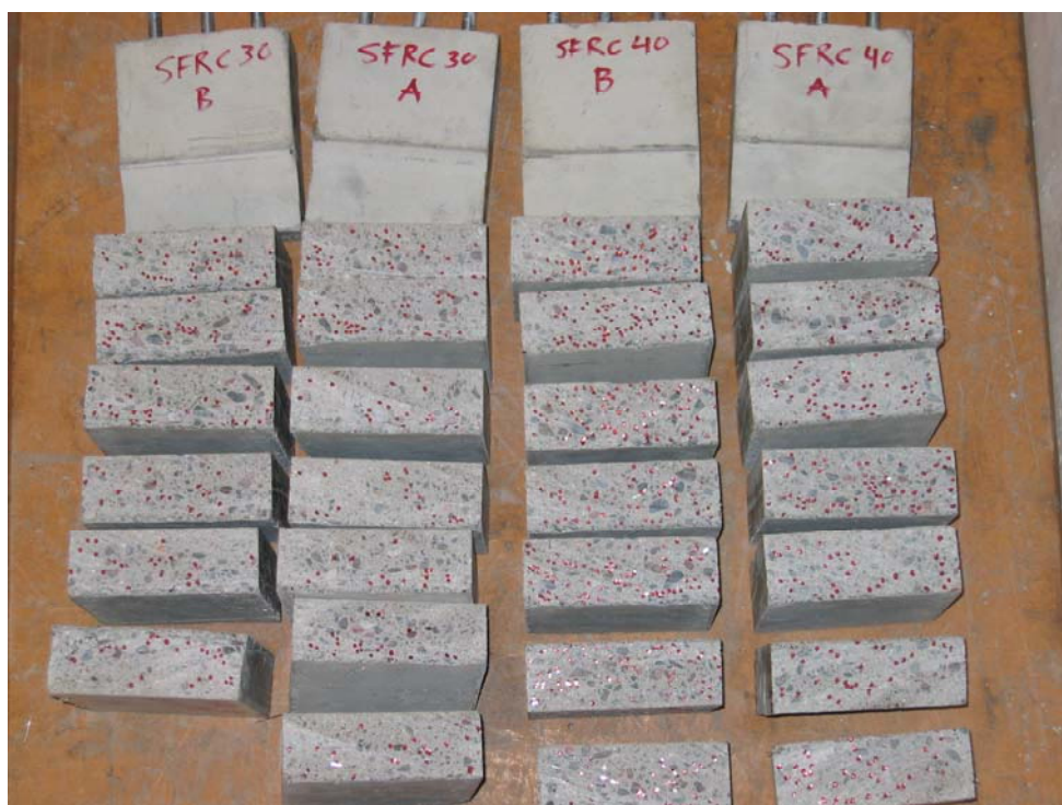
Figur 11 – Uppsågade provkroppar där synliga fibrer har markerats med röd färg.
