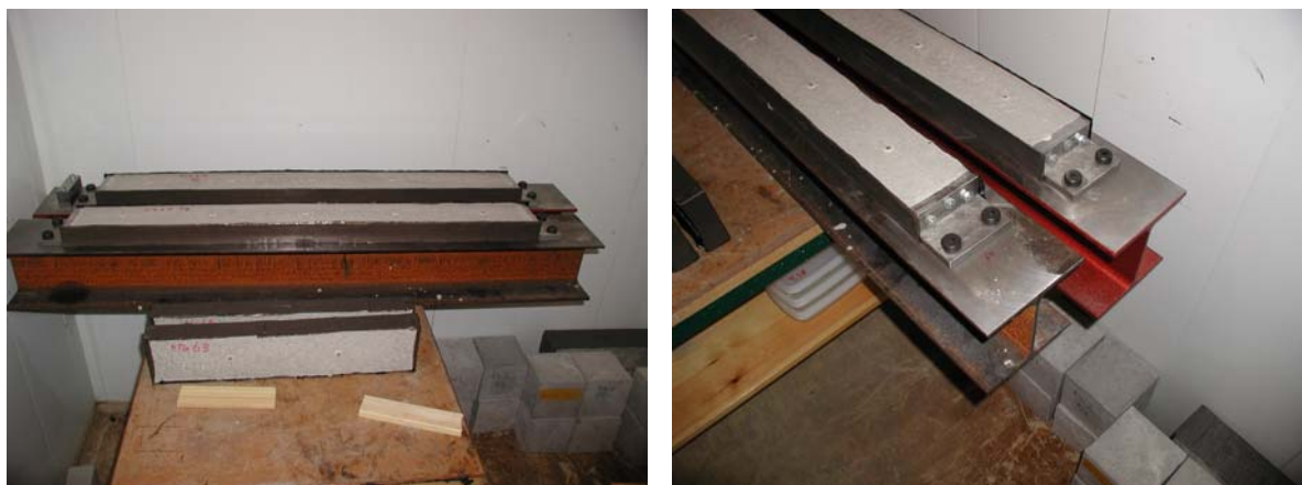
Figur 2 – Testriggar för studie av spricktillväxt i betong utsatt för ändförhindrad krympning.
